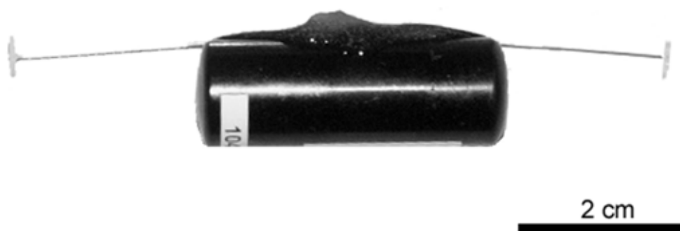
Figura 13. Imagen de un transmisor de telemetría (pinger) mostrando las T-tags pegadas mediante resina epoxi, preparado para ser insertado sobre un pez. Los transmisores para L. bergylta y D. labrax fueron provistos de un tercer punto de anclaje (consultar la sección de material y métodos para más detalles).
